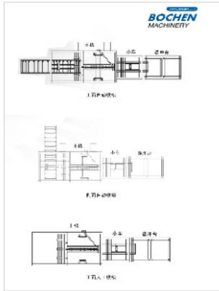
**智能翻转收纸机：**全自动翻转收纸机是裱纸机的配套产品，其包括依顺序组接的一缓送台，一叠纸台，一翻转台及一收纸台，其中，通过缓送台与裱纸机组接，并将纸张堆栈成纸堆后送入该翻转台内，利用翻转台内的皮带翻转机构，将纸堆依序一次翻一次不翻地送至翻转台顶部，再以皮带输送机构送入分纸机构后进入收料台顶部内，经整纸机构整纸后落至收料台的栈板上，借此，达到全自动化进行纸张计数，纸张翻转及纸张堆栈，具有整平裱贴后的纸张及大幅减少人力资源且有效提高收纸效率等效果。减少人工收纸强度。新款翻转收纸机采用全新设计的收纸笼，彻底解决了老款翻转收纸机在生产过程中，翻转后纸张与金属碰撞所产生的压痕。天津纸箱翻转机生产厂家使用翻转机前的注意事项：非相关人员请勿对机器做出维修。
